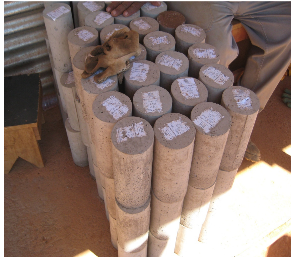
Foto 21 – Ensaio – Corpos de prova identificados para análise de laboratório
