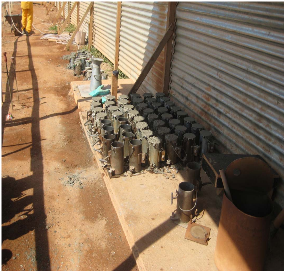
Foto 20 – Ensaio – Moldagem de corpos de prova
